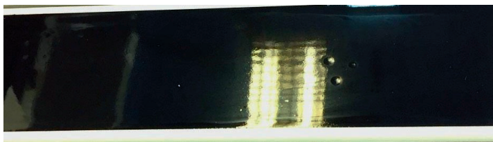
Fot. 3. Żywica epoksydowa z błyszczącą powierzchnią.
