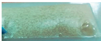
Fot. 1. Nieodgazowana żywica poliuretanowa, efekt pianki.
