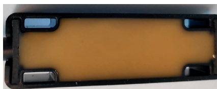
Fot. 2. Moduł elektroniki firmy GoUpGo zalany odgazowaną żywica ST13, po utwardzeniu.
